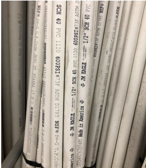
Tubería blanca de PVC con etiqueta de NSF residuales
